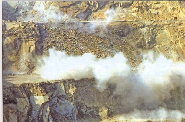
Der Neustifter Granit hat sich in vielen übereinander liegenden Schichten mit einer maximalen Mächtigkeit von 1 m abgelagert und ist somit relativ dünnbankig. Daher werden für seinen Abbau wenig brisante Sprengstoffe eingesetzt, um das Gestein zu schonen
